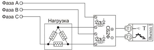
Использование двухфазных силовых блоков для управления трехфазной нагрузкой.
