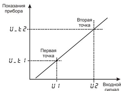
Датчики с унифицированным токовым выходом 4...20 мА подключаются к входу прибора через шунт 2 Ом.
